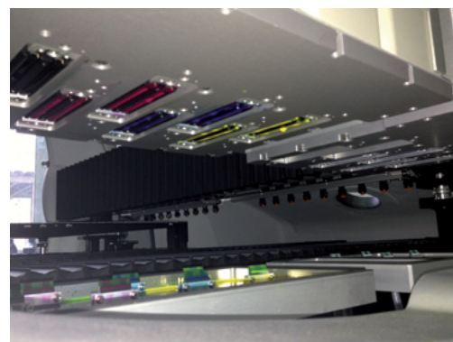
Die neue Avalanche arbeitet mit 16 Druckköpfen für die Prozessfarben und 8 Köpfen für Weiß, dank denen Promotexx bei einem A4-Format stündlich 100 farbige oder schwarze Shirts verdeln kann.
